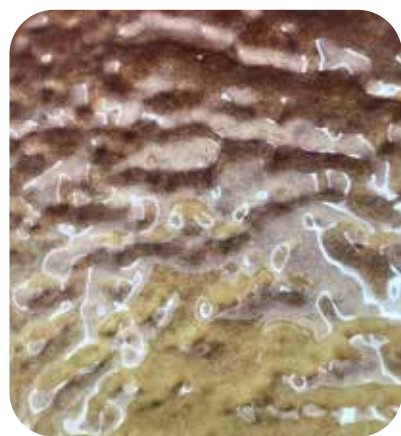
Obr. 1: TP303 (0,5 hmot. %) v glazure pro výrobu repliky vnitřního obkladu před a po vypálení
