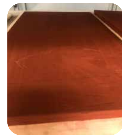
Obr. 4: Vybarvení syrové fasádní desky pomocí TP303 (3 hmot. %)
