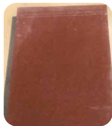
Obr. 3: Vybarvení keramické slinuté dlaždice pomocí TP303 (3 hmot. %)
