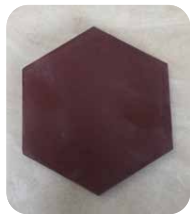
Obr. 2: Vybarvení keramické hmoty pro fasádní pásy pomocí TP303 (3 hmot. %)
