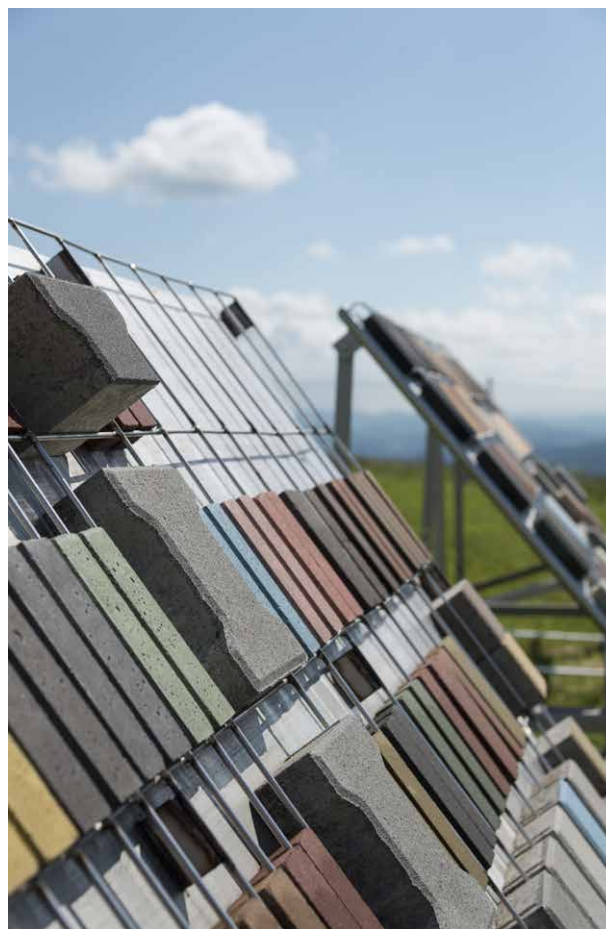
Obr. 2 – Probarvené betonové vzorky na povětrnostní stanici Maruška (Foto: Fabian)
